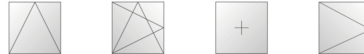
Verschiedene Öffnungsvarianten wie Dreh, Kipp und Kipp vor Dreh usw. können mit handelsüblicher Beschlagstechnik realisiert werden. Es können sowohl aufliegende, als auch verdecktliegende Bänder zum Einsatz kommen.
